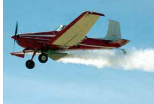
吸湿性パウダーを散布するのに使用されたシーディング用航空機。ヘブライ大学 Rosenfeld博士提供
